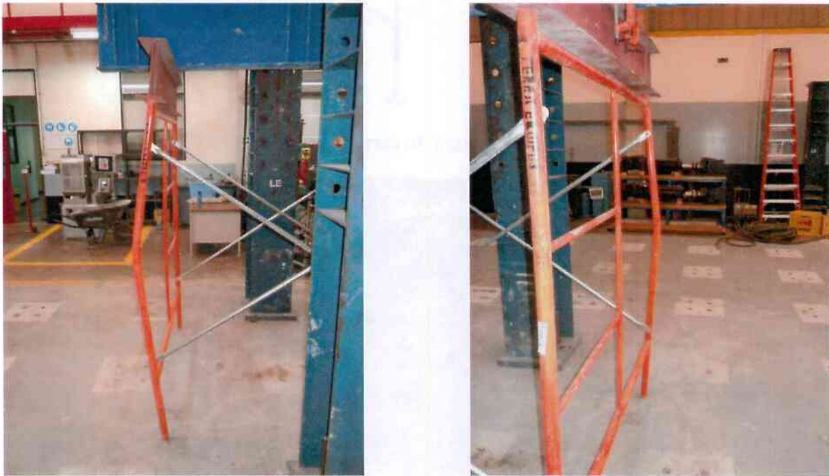
Figura 3: Falla por pandeo de elemento vertical del marco.
