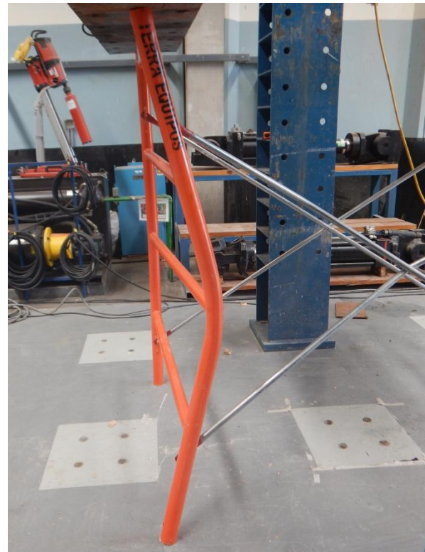
Figura 3. Falla en el andamio, muestra 0210-18.
